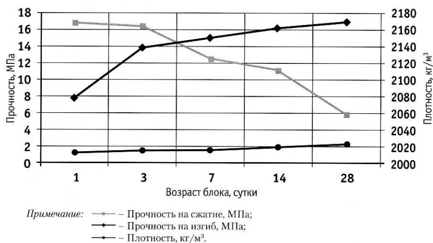
Рис. 6. Изменение плотности и прочности стабилизированных блоков с 12 % цемента во времени
