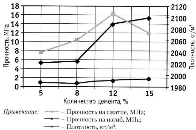
Рис. 5. Зависимость предела прочности на сжатие R_{сж} и изгиб R_{изг} блоков от количества цемента в грунтопесчаной смеси
